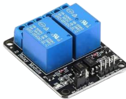
GPIO Relais (elektromagnetischer Schalter)
