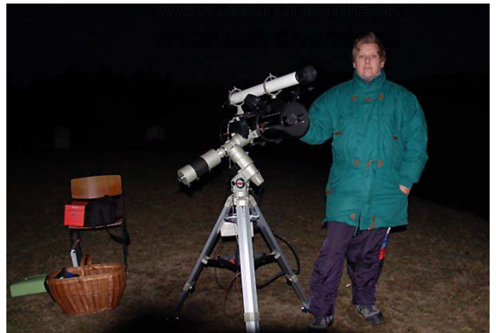
Unten: Sven Berger: Vixen 6" f5 Newton Kamera: DSLR Nikon D70 Montierung: Vixen GP+Skysensor 2000PC, Gahberg
